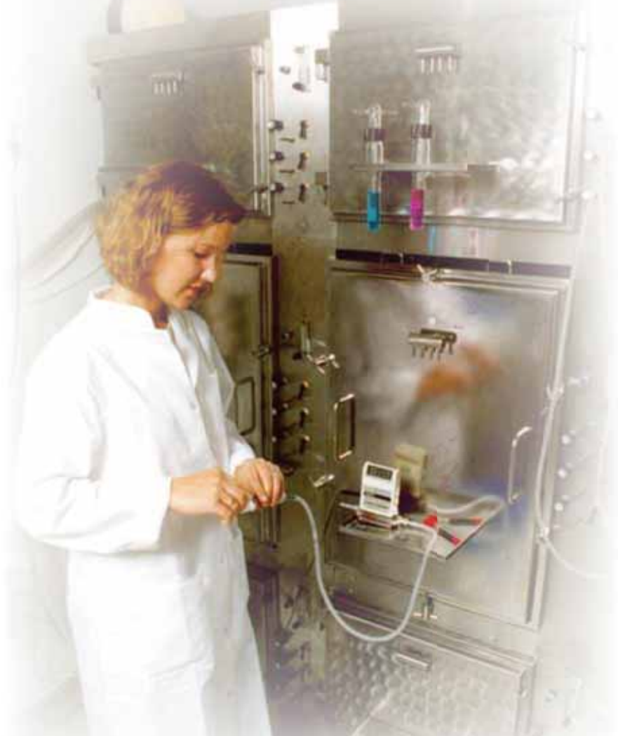
In der Prüfkammer werden chemische Stoffe freigesetzt und mit Messrohren für die Analyse gesammelt.
